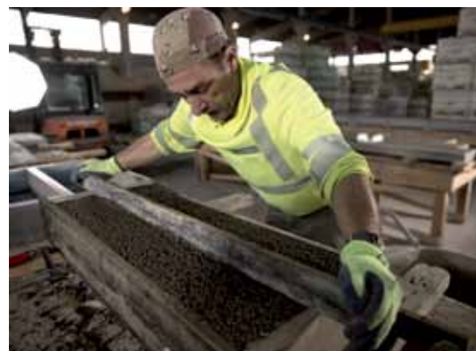
Massivarbeiten, wie Blockstufen oder Palisaden werden mit hochwertigem Betongemisch von Hand befüllt und zu einem erstklassigen Werkstück gefertigt.
