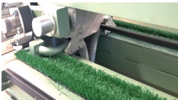
Ein Prüfverfahren zum Austrag von Mikroplastik bei Kunststoffrasen entwickelt derzeit eine FLL-Arbeitsgruppe. Foto: FLL
